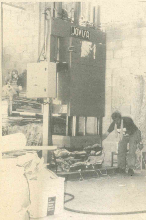
Prensado de balas de 90 kilos. Fundación Deixalles, Mallorca
